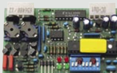
Induksjonssløyfe-prosessor Kretskort med 1 eller 2 kanaler. Egner seg for 2 adskilte induksjonssløyfer uten sløftekabel.
