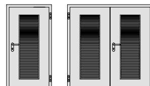
Ventilasjongitter, størrelse etter valg, kantbredde hele veien rundt min. 180 mm
